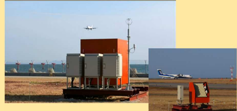
空港用SOLWIN (T-R 1台、R 2台) バイスタ型 2 kHz
