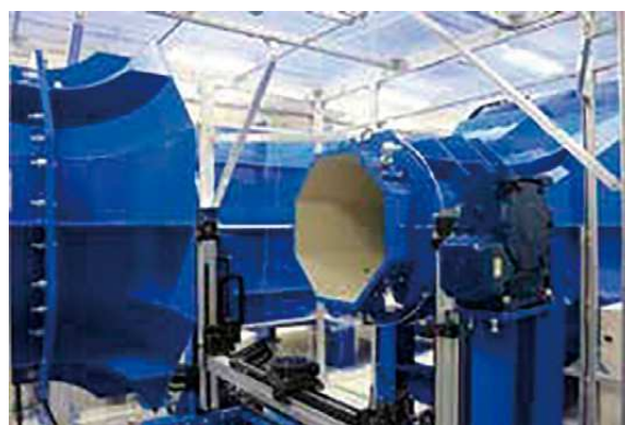
図3 90m/sの風速が校正可能な風洞設備(ソニック)
