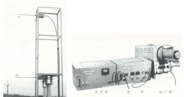
超音波風速計の国産試作1号機
